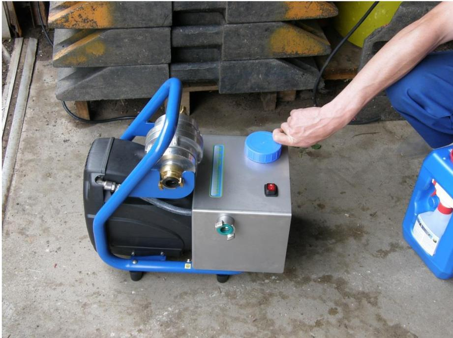
Mobile Desinfektionsstation für Trinkwasserschläuche
